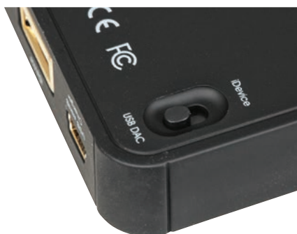
Wyboru wejścia (USB do komputera lub USB dla iUrządzeń Apple) dokonujemy małym hebelkiem na spodzie urządzenia.
