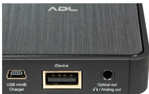
Złoczone styki w gniazdkach USB nie trafiają się często nawet w dużo droższych USB-DAC-ach.
